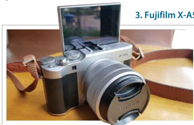
Kamera yang memiliki desain bodi berbahan logam yang dilapisi dengan kulit berbahan sintesis ini memiliki tampilan yang mengusung tema klasik. Untuk spesifikasinya kamera ini dibekali dengan sensor CMOS beresolusi 24.2 MP, shutter speed 1/4000 to 4 sec, built-in flash, serta memiliki rentang ISO 200 hingga 12800 (*Extendable* 100, 25600, 51200).
