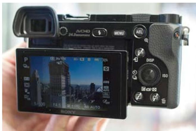
Kamera *mirrorless* yang banyak digemari oleh kalangan fotografer ini memiliki desain tampilan yang cukup klasik. Disamping itu kamera ini juga dibekali dengan sensor CMOS beresolusi 24 MP, shutter speed 1/4000 to 30 sec, built-in flash,
